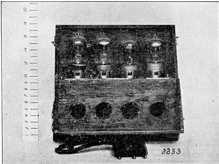
Fig. 132. Lorenz vierlamp smoorspoel-hoogfrequentversterker, (tevens geschikt voor middelfrequentie's). De foto toont den versterker met neergeslagen deksel.
