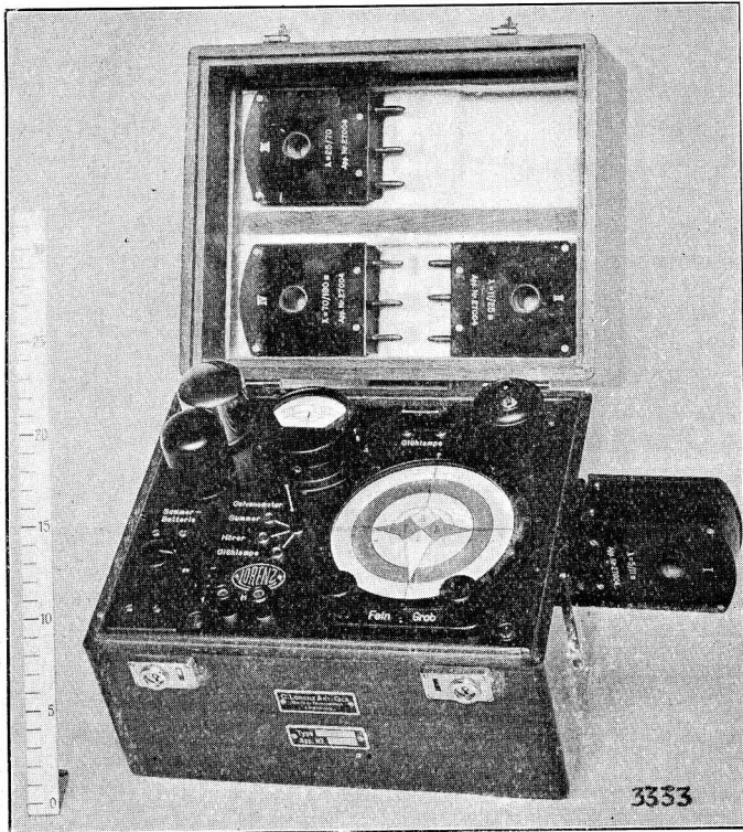
Fig. 42. Lorenz-golfmeter voor korte golf met diverse resonans-indicatoren, voor gebruik bij ontvangers en bij zenders.
