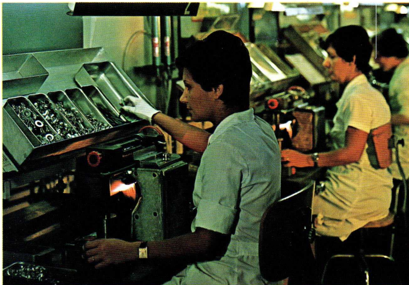
Foto 2 - Operazione di assemblaggio cannoni elettronici Electron gun assembly operation
