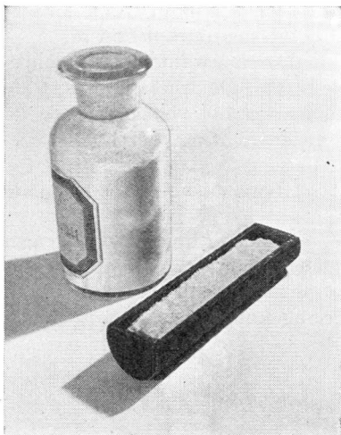
Fles met germaniumdioxide-poeder; daarnaast een schuitje met zeer zuiver germaniumdioxide.
