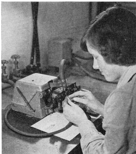
Het solderen van germaniumkristal op houder.
