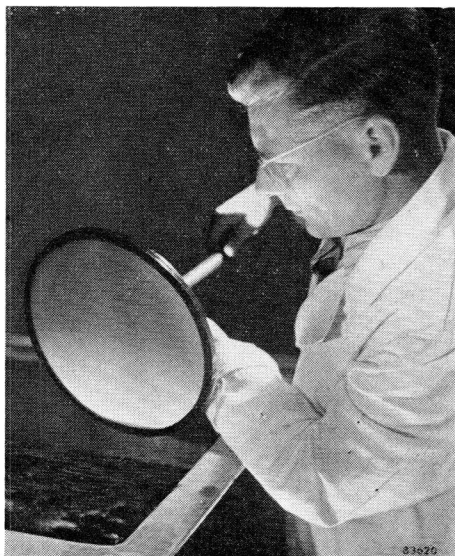
Fig. 14. Galvanisch bad waarin een „vader” gemaakt wordt.
