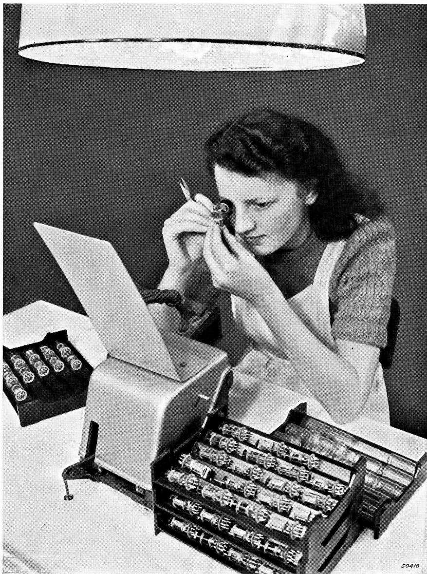
Contrôle van de opbouw van het electrodensysteem
