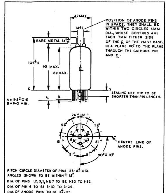
THE END OF THE PINS SHALL BE TAPERED OR ROUNDED.
