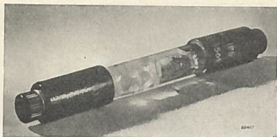
Fig. 3. Normaalement, dat de ijkspanning voor de P_H -meter levert.
