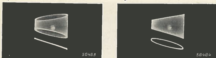
Fig. 14. Lissajous oscillogrammen van een gemoduleerde draaggolf en van de L.F. uitgangsspanning van een trillingsopnemer, beide via een elektronische schakelaar GM 4581 aan de platen voor verticale afbuiging van de oscillograaf gelegd. Tussen de modulatiespanning en de opnemer-spanning is een verschil in fazehoek van 40^\circ . De tijdas wordt verkregen door middel van een sinusvormige spanning met dezelfde frequentie, die afkomstig is van de faze-indicator.
