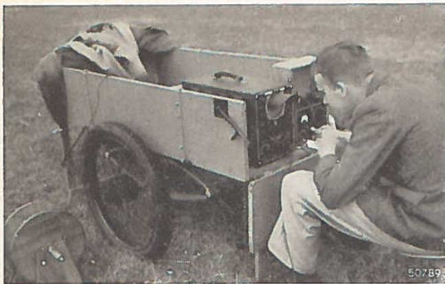
Fig. 7. De verplaatsbare apparatuuropstelling. Men ziet de oscillograaf GM 3156 en het amplitude-meetapparaat GM 5522.
