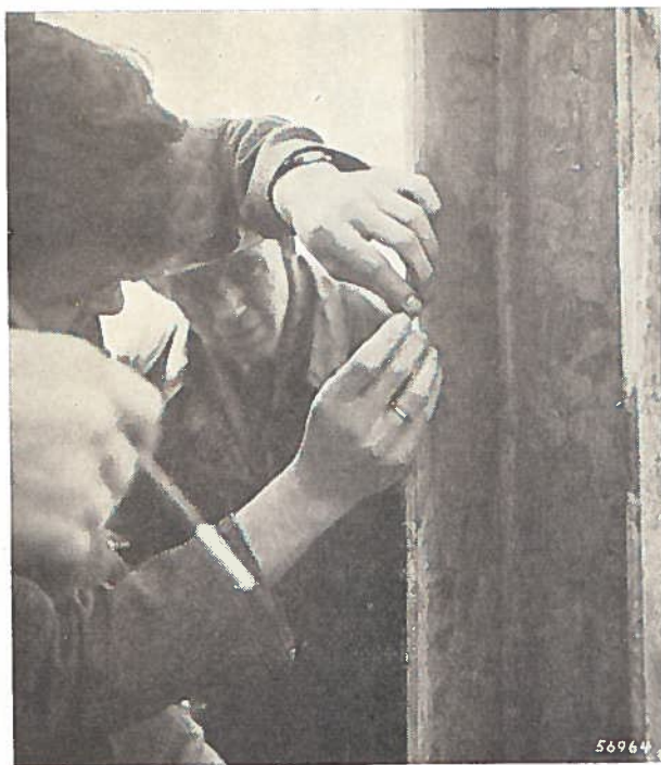
Fig. 3. Het bevestigen van een rekstrookje (links) op een vlakgevijld rand van een dubbele T-balk.
