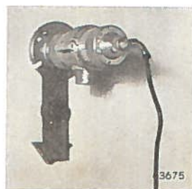
Fig. 4. Speciale trillingsopnemer GM 5520, aan de muur geklemd.
