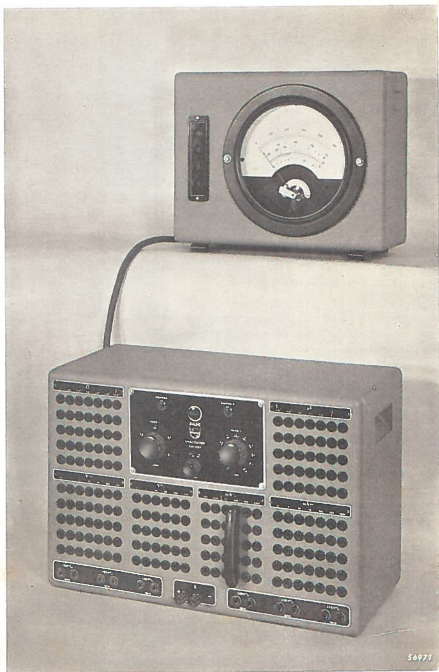
Fig. 1. Het universele meetapparaat GM 4257 en de aparte kast voor het wijzer-instrument met de signaallampjes voor de indicatie van de te gebruiken schaal.
