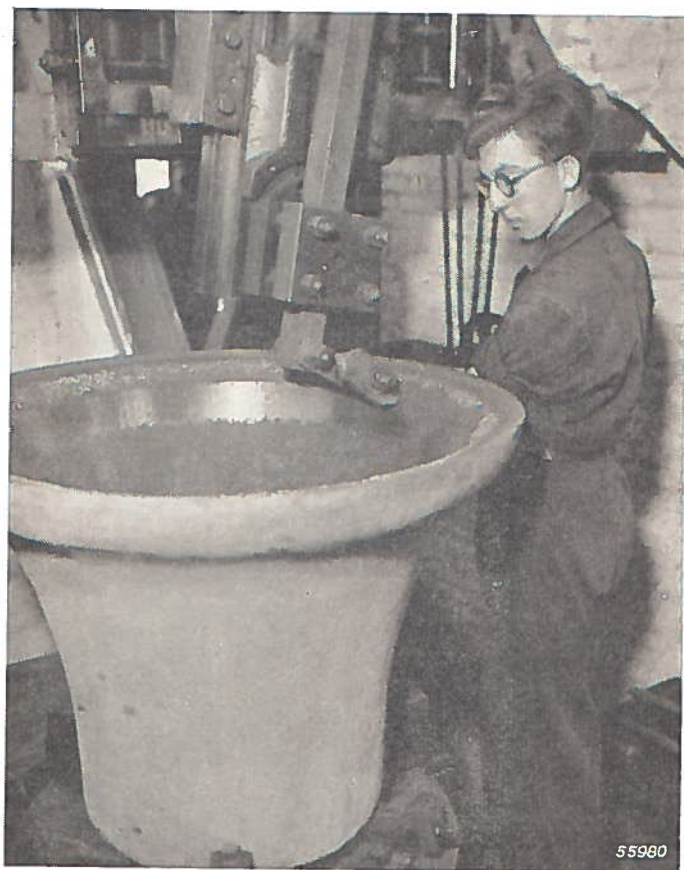
Fig. 12. Het uitdraaien van een klok ten einde de correcte verhouding tussen de verschillende eigenresonanties te verkrijgen (foto genomen bij de firma Eijsbouts).
