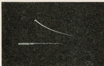
Fig. 16. Een oscillogram opgenomen ter bepaling van de inschakeltijd van de magnetische schakelaar M van fig. 9, welke men verkrijgt als deze schakelaar een gelijkstroom inschakelt. Op dit oscillogram is eerst een nullijn gefotografeerd.
