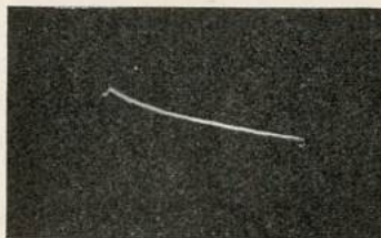
Fig. 10. Oscillogram van de stroomstoot door een gloeilamp, welke optreedt na het inschakelen van de gelijkstroom.
