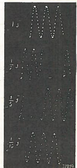
Fig. 2. Opnamen ter bepaling van de belichtingstijd met een sinusvormige baan van de lichtvlek.
