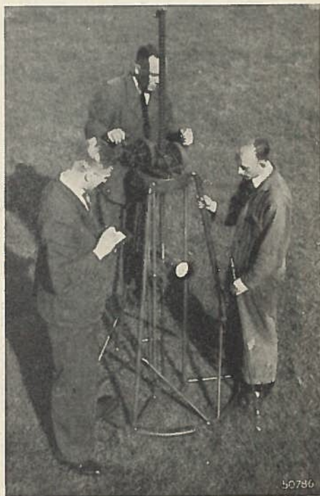
Fig. 2. Apparaat waarmee op regelmatige diepten de weerstand registreert, die bij het indringen in de bodem wordt ondervonden door een staaf welke aan het ondereinde is voorzien van een conus.
