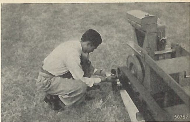
Fig. 6. Het bepalen van de trillingfrequentie door middel van het toerental van de trillingexcitator.
