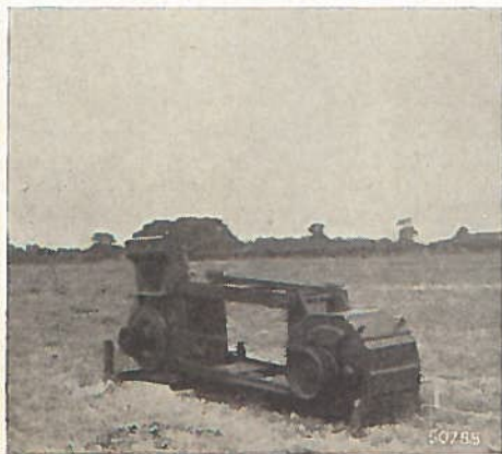
Fig. 5. Trilling-excitator welke is gebaseerd op centripetaalkrachten van roterende massa's. Deze excitator wordt aangedreven door een benzine-aggregaat.
