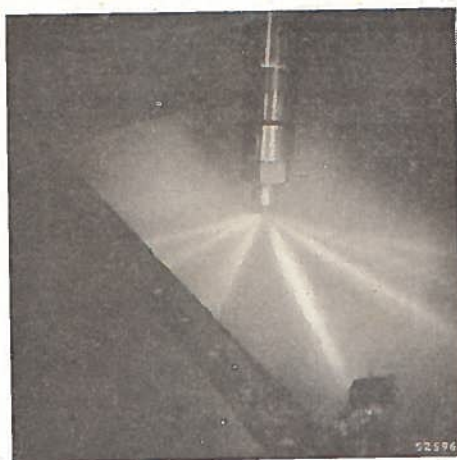
Fig. 13. Contrôle van een brandstof-inspuiting.
