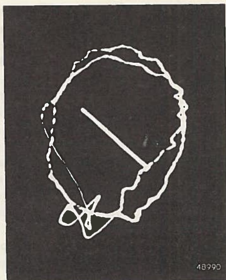
Fig. 5. Diagram van een asbeweging. Duidelijk zijn de ijklijnen en het gestippelde gedeelte zichtbaar.
